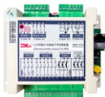
Modbus Tcp接收器
