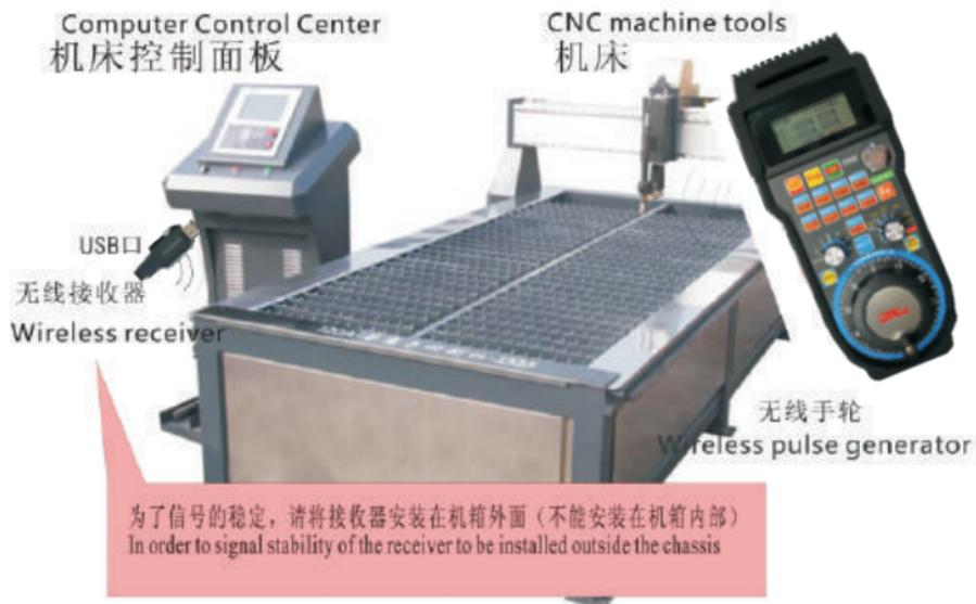
注意：为了信号的稳定，请将接收器安装在机箱外面（不能安装在机箱内部）
