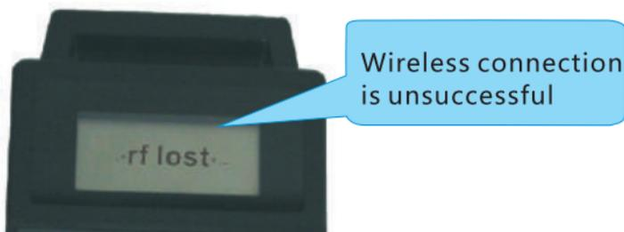
当无线MPG和USB接收器连接不成功（比如USB接收器没有插上电脑），则无线MPG的LCD会如下显示：
